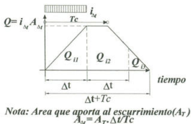
Fig.N°.5.5: Hidrograma de una celda con intervalo de tiempo de análisis menor a su tiempo de concentración, \Delta t < T_c .
